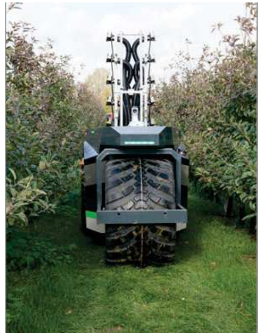
Der große Vorderreifen hat eine sehr hohe Tragfähigkeit. Bei maximal 10 km/h kann der Reifen bei 0,8 bar 3.000 kg tragen. Bert van Sonsbeek
