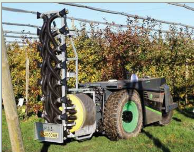
Aktuell ist ein Spritzmodul bereit für den Einsatz. Der Spritztank mit einem Inhalt von 2.000 Litern wird auf dem Grundgerät montiert.
