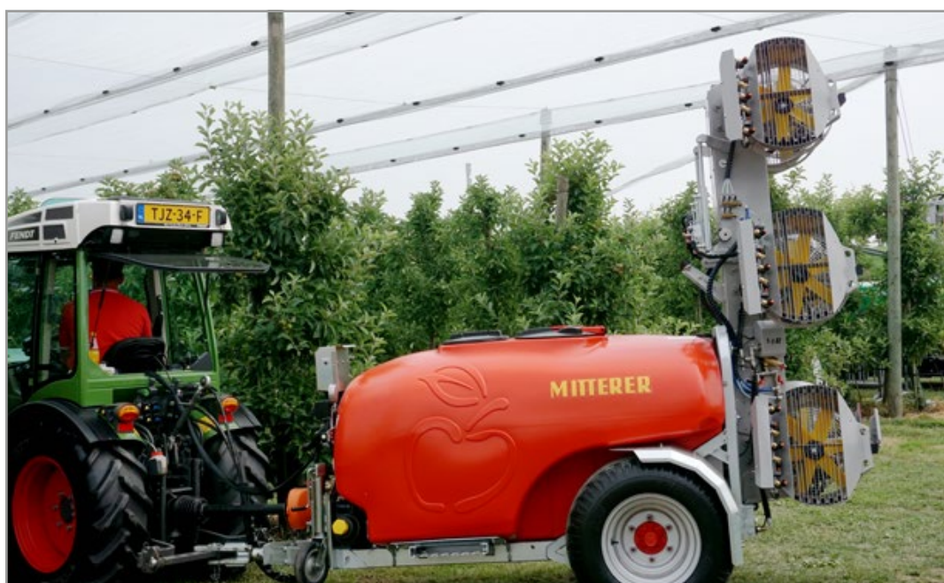
De fruitteeltspuit van Mitterer heeft zes hydraulisch aangedreven instelbare ventilatoren. Bert van Sonsbeek
