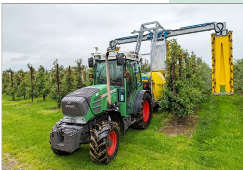
De drierijige spuitmachine van KWH is uitgerust met het variabele spuitsysteem van BBLeap. BBLeap
