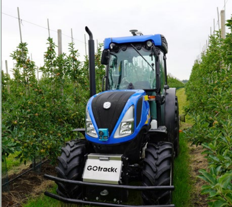
Tractor uitgerust met het systeem van GOtrack voor autonoom rijden
