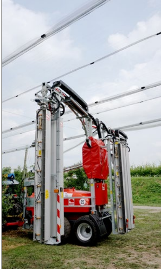
De drierijige spuitmachine van Wanner heeft zes dwarsstroomventilatoren. Bert van Sonsbeek
