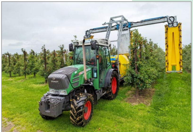
Das dreizeilige Sprühgerät von KWH ist mit dem variablen Sprühsystem von BBLeap ausgerüstet. BBLeap
