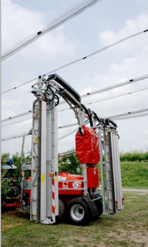
Das dreizeilige Sprühgerät von Wanner verfügt über sechs Querstromventilatoren. Bert van Sonsbeek
