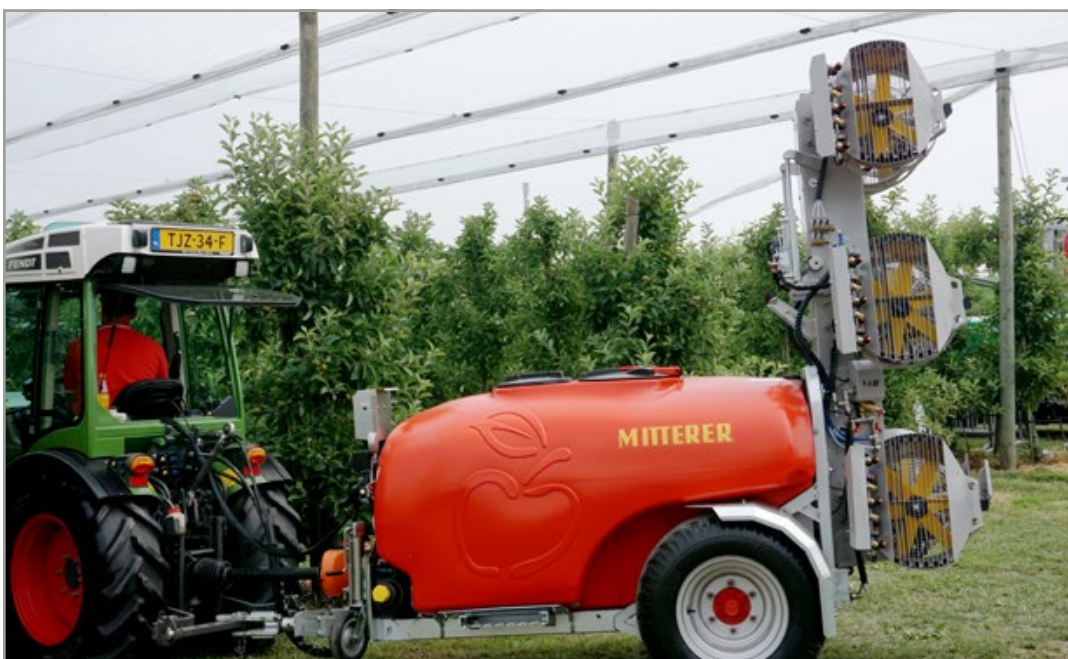
Das Sprühgerät von Mitterer hat sechs hydraulisch angetriebene, einstellbare Ventilatoren. Bert van Sonsbeek
